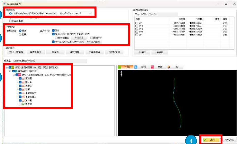
出力形式は「3次元設計データ交換標準(案)形式 (J-LandXML)」を選択します。
