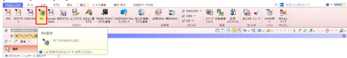
[IFC エクスポート]ウインドウが起動します。「IFC ファイルとリンクファイルを zip 形式でまとめる」にチェックをつけて [OK] を選択します。これにより、オブジェクトにリンクしているファイルと IFC ファイルをまとめて、1 つの zip ファイル形式で出力します。
