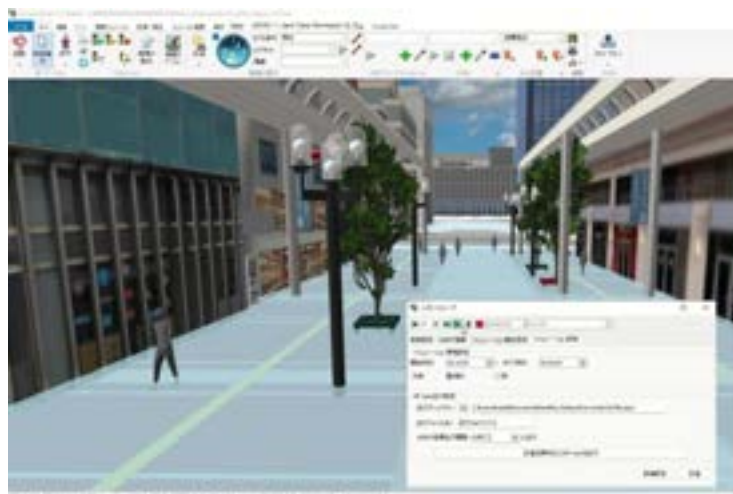
左：再生ボタンで人流シミュレーションを開始。混雑度のヒートマップ表示も可能 右：人流可視化Webアプリ
