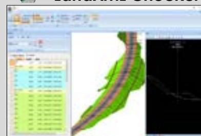
「LandXML1.2に準じた3次元設計データ交換標準の運用ガイドライン(案)」に定められた照査方法に対応
