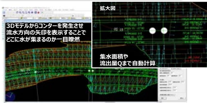
流水方向と集水面積、流出量Qの自動計算
