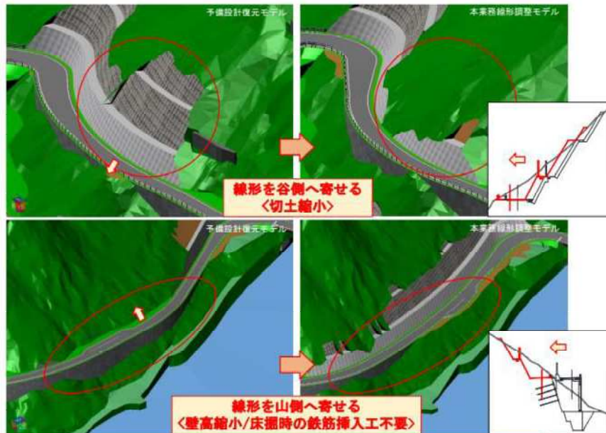
図 3-2 路線選定において活用する BIM/CIM モデルの例
