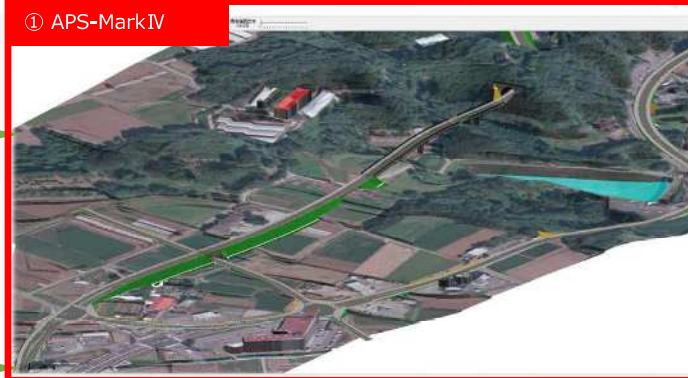
線形検討 (平面・縦断線形計画~法面展開)、3Dモデルで可視化
