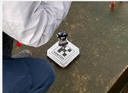
① 任意の箇所にKENTEMマーカを配置。「快測ナビ」でマーカ中心を観測
