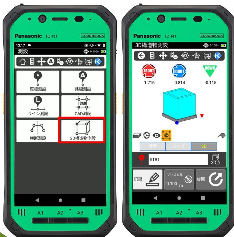
「SITE-STRUCTURE」「SITE-NEXUS」にて現場座標で作成した構造物モデルを使用して測設。構造物モデルの端点をスナップし、モデルの座値に誘導することが可能です。
