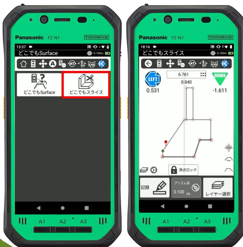
「SITE-STRUCTURE」「SITE-NEXUS」にて現場座標で作成した構造物モデルをスライスし、スライスした断面との差をどこでもガイド。スライスは、路線・エッジ・標高を基準としてスライスすることが可能です。
