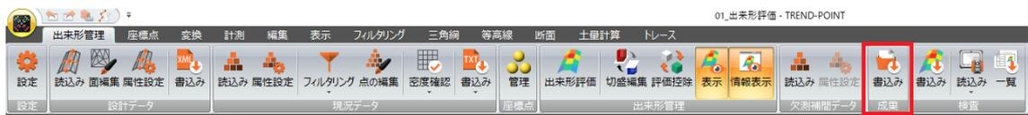
「LandXML1.2 に準じた 3 次元設計データ交換標準（案）に準拠」のチェックを ON、バージョンと事業段階を選択して確定し、出力先を指定する
