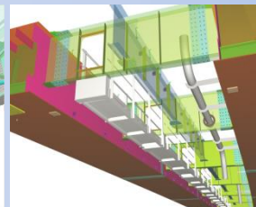
鋼箱桁・検査路・排水管 (MASTERSON, Braz)
