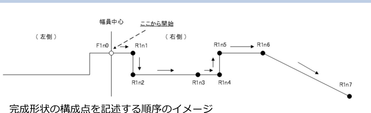
幅員中心と左右の横断構成要素イメージ
