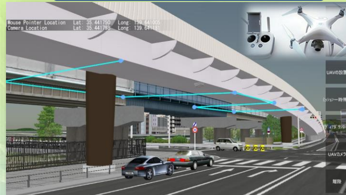
UAVによる維持管理シミュレーション
