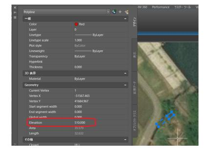
Step4:「ツールスペース」パネルの「ツールボックス」タブから「Subscription Extension Manager」->「 Autodesk Shared Reference Point」->「Export Shared Reference Point for Autodesk Revit」の右クリックメニ ューから、「実行」を選択します。「Select Origin Point:」で赤枠の左下を端点スナップでクリックします。「Select a point on +Y axis('quasi-north'):で赤枠の右下を端点スナップでクリックします。「Select Units and Confirm」ダ イアログで Z 値が正しく入っていること、「Select DWG Units」が「Meters(M)」になっていることを確認して「OK」 をクリックします。
