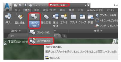
「ブロック書き出し」ダイアログで「図形選択」ボタンをクリックし、ソリッドとしたトンネルコリドーと舗装面を選択し てキーボードから「Enter」キーを入力します。ファイル名に「トンネルソリッド書き出し.dwg」と入力し、OK をクリッ クします。
