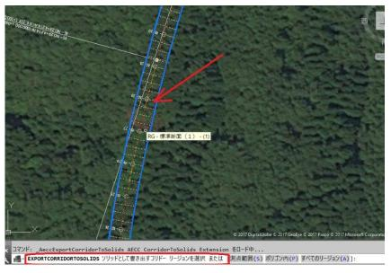
「コリドーからソリッドを作成」ダイアログの「出力オプション」で、作成オブジェクトタイプを「AutoCAD 3D ソリッド (コリドー抽出に基づく)」を選択し、「出力先オプション」で「現在の図面に挿入」を選択して、「ソリッドを抽出」ボタ ンをクリックします。
