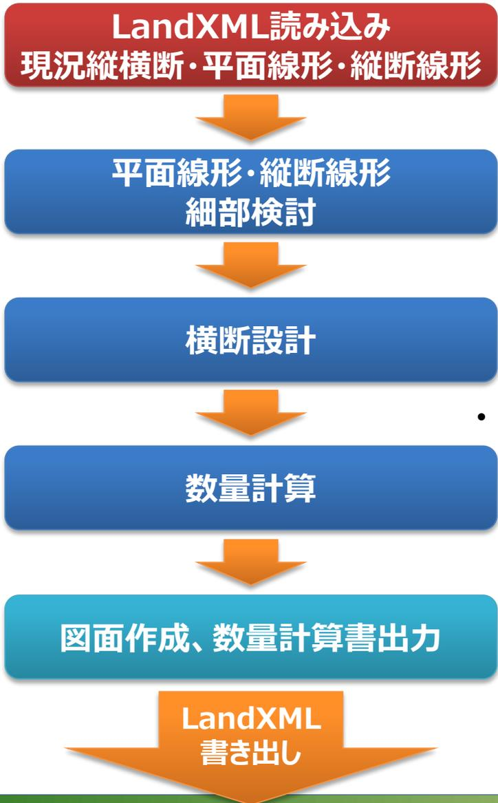
LandXMLから路線測量で作成した現況縦横断を読み込み
