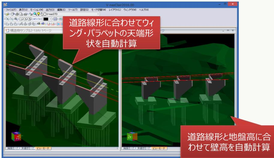
橋梁下部工、ボックスカルバート工のモデル作成が簡単に可能
