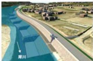
図-1 萩原地区の3次元築堤モデル
