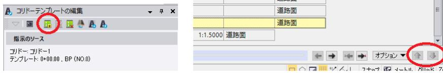
指示データの参照元ノード、(新しいノードの) 名前を変更してノードの接続を調整して下さい。また、法面を突き当てる現況地形を変更する場合は、側斜面の指示データのターゲットテンプレートを変更して下さい。
